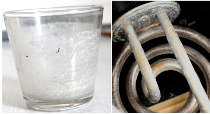
Abbildung 2: Links: Mit Kalkablagerungen verschmutztes Glas, vor dem Reinigen. Rechts: Mit Kalk verschmutzter Wasserkocher, vor dem Reinigen.
