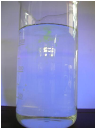
Abb. 5: Eintropfen der Fluorescein-Lösung in Wasser.
