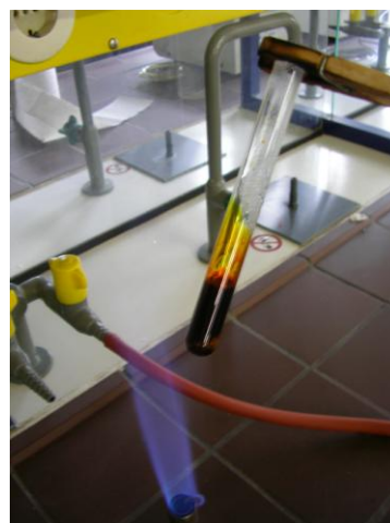
Abb. 2: Erhitzte Schmelze von Fluorescein.
