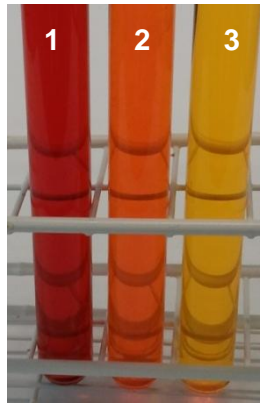
Abb. 6: In basischer Lösung (1: pH = 13) tritt eine rote, in neutraler Lösung (2: pH = 7) eine orangene und in saurer Lösung (3: pH = 2) eine gelbe Färbung ein.
