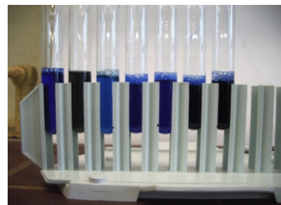
Abb. 4 Brillantblau Deutliche Farbänderung in den Reagenzgläser mit konzentrierter Salzsäure, Ammoniak und Natronlauge
