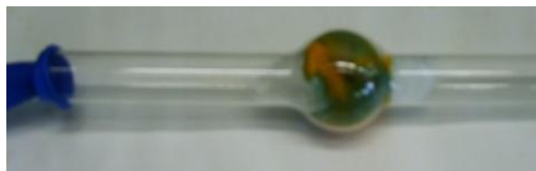
Abb. 2: Nach Entlüften des Luftballons färbt sich das Kieselgel grün
