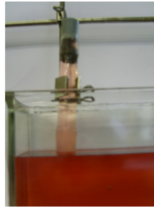
Abb. 2: Versuchsaufbau Bestimmung des Luftsauerstoffs mit Stahlwolle
