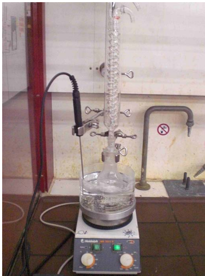
Abb. 1. Versuchsaufbau. Erhitzen unter Rückflusskühlung
