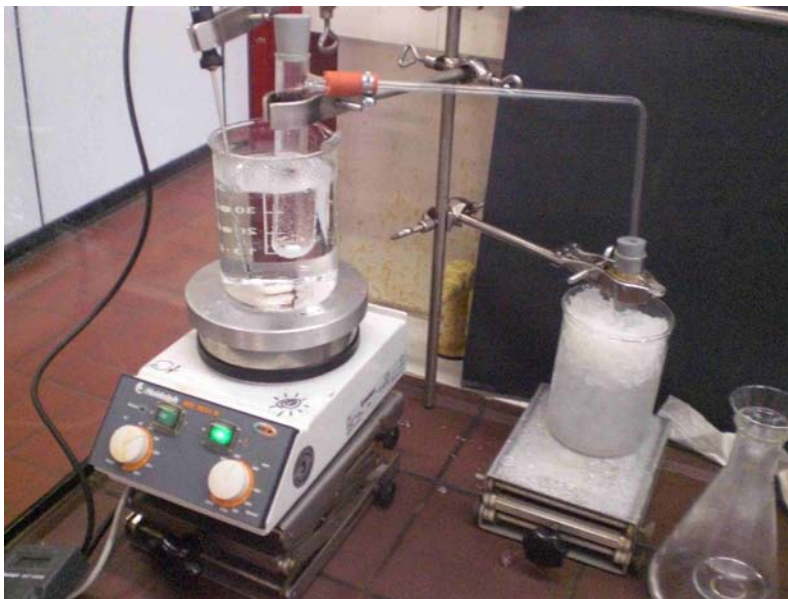
Abb. 1: Destillationsapparatur. Nach der Aufnahme des Fotos wurde die Apparatur im oberen Bereich mit Alufolie umwickelt.
