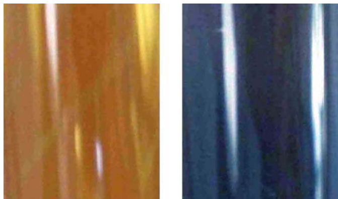
Abb. 4: Farbveränderung nach Zugabe der Lugolschen Lösung (Glucose-Lösung, links; Stärke-Lösung, rechts). Anmerkung: Vergrößerte Darstellung, um die farbliche Veränderung besser darzustellen.
