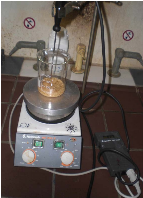
Abb. 1: Mit Schwefelsäure versetztes Sägemehl
