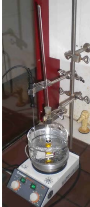
Abb. 1.: Versuchsaufbau mit Rückflusskühlung
