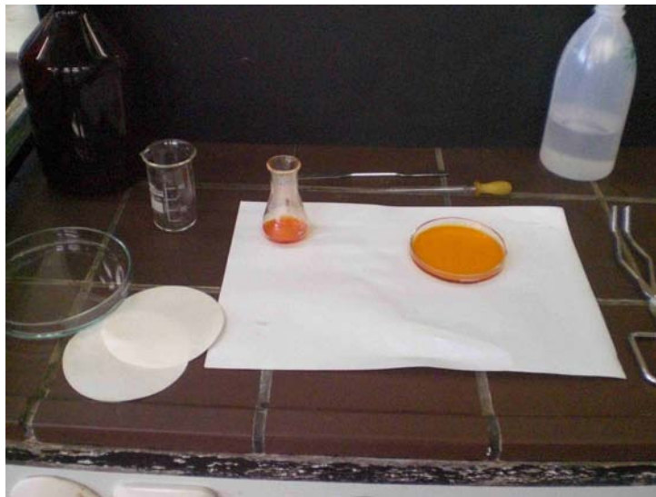
Abbildung 1: Einfacher Alkoholtest mit Kaliumdichromat-Lösung
