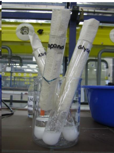
Abb. 2: Reagenzgläser mit langem saugfähigem Stopfen.
