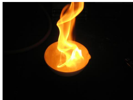
Abb. 4: Verbrennung des Kondensats.
