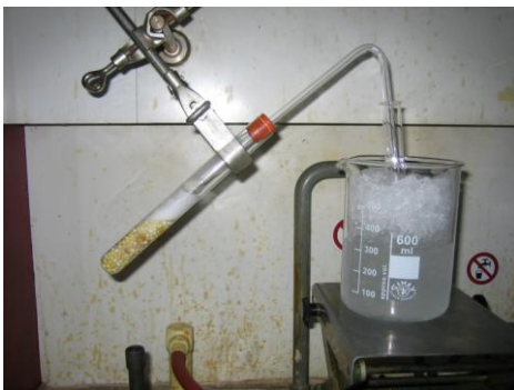
Abb. 1: Versuchsbeginn mit hellem Perlkatalysator.
