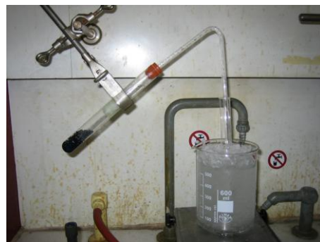
Abb.2: Versuchsende mit schwarzem Perlkatalysator.
