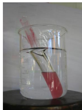
Abb. 4: Erhitzen im Wasserbad.
