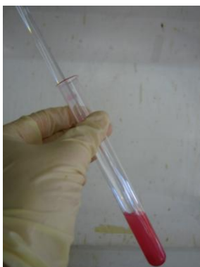
Abb. 3: Bildung einer homogenen Phasen zwischen Styrol und Härterpaste.
