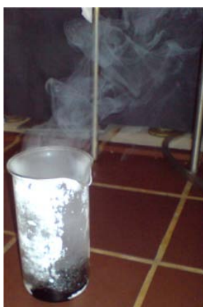
Abb. 3: Bildung eines schwarzen, aufgeschäumten Berges und Entwicklung von Dampf.
