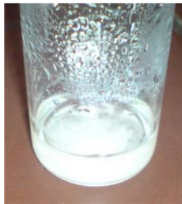
Abb. 4: Gebildeter weißer Niederschlag der Sprite-Lösung ® nach dem Erhitzen.
