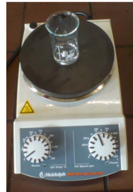
Abb. 2: Vorbereitetes Becherglas mit Rührfisch und Analysesub- stanz.
