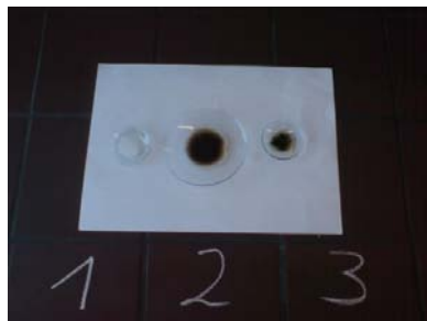
Abb. 6: Mit konz. Schwefelsäure versetzte Niederschläge nach 3 Tagen [1 ≡ (III), 2 ≡ (I), 3 ≡ (II)].
