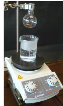
Abb. 2: Rundkolben mit Kaffeepulver und Wasserbad.
