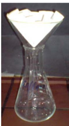
Abb. 3: Erlenmeyerkolben mit Faltenfilter.
