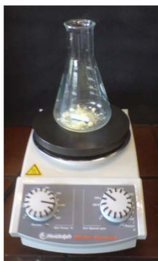
Abb. 1: Magnetrührer mit Erlenmeyerkolben und 2-Nitrobenzaldehyd.
