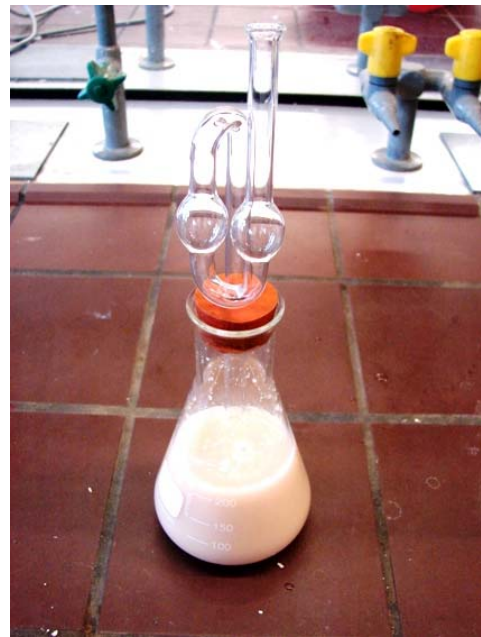
(oben: Gärvorrichtung mit Gärröhrchen)
