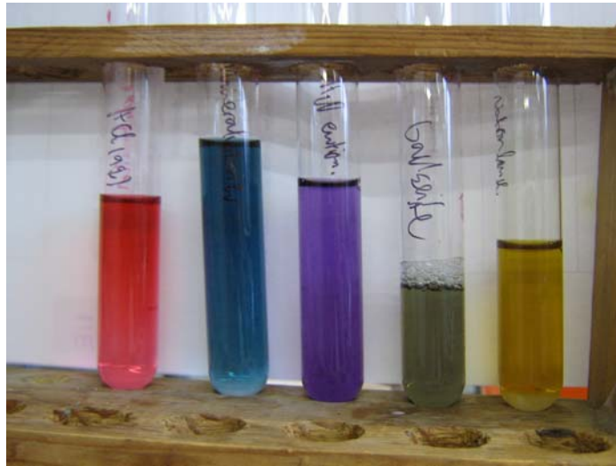
Indikator mit Essig, Sodalösung, ention. Wasser, Schmierseife, konz. Natronlauge (v.l.n.r.)
